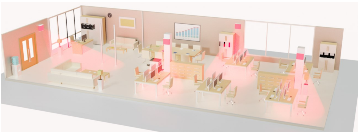
Abbildung 2: Wi-Fi 4 Versorgung mit mehreren Access Points im Raum. Wi-Fi 4 unterstützt MIMO mit mehreren Antennen, kann also Signale in bestimmte Richtungen fokussieren (Konzeptdarstellung).
